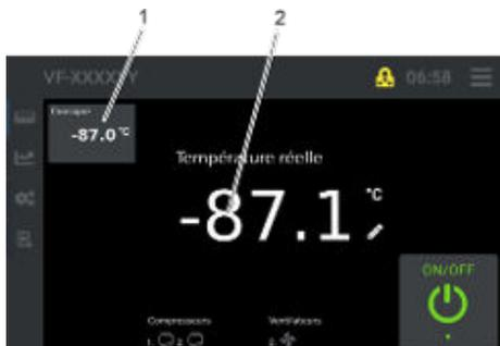
Fig. 116 : Icône Valeur de consigne de la température de l'enceinte réfrigérée
