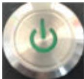
Fig. 12 : Interrupteur de batterie principale pas enfoncé
