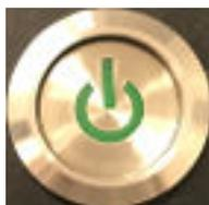
Fig. 60 : Interrupteur de batterie principale enfoncé
