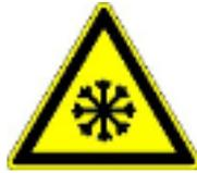
Des symboles d'avertissement « Surface froide » sont apposés sur l'appareil. Ce symbole attire l'attention sur les surfaces froides sur l'appareil. Tout contact avec ces surfaces est interdit durant le fonctionnement. Avant de toucher ces surfaces pour des interventions telles que la maintenance, des équipements de protection individuels doivent être utilisés.
