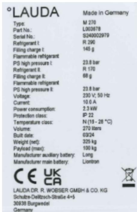
Fig. 17 : Exemple\_plaque\_signalétique
