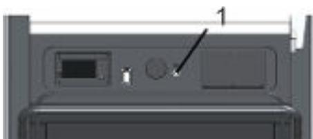
Fig. 48 : Interrupteur de batterie principale
