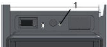
Fig. 54 : Interrupteur de batterie principale
